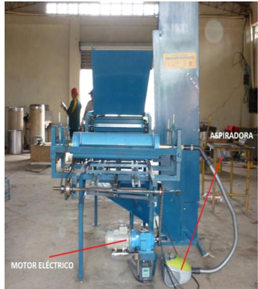
Foto 3. Ubicación del motor y de la aspiradora
