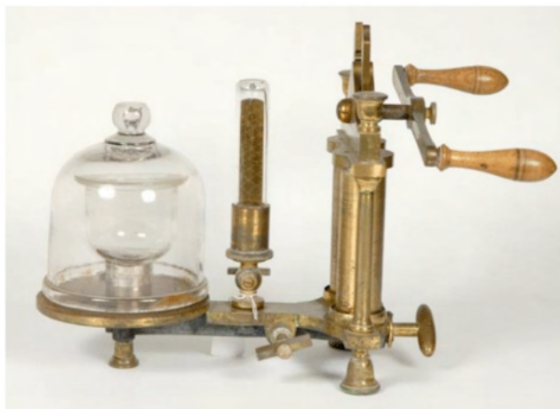
Fig. 9 - Máquina pneumática de dois corpos - Projecto POCI/CED/60998/2004 - <baudafisica.web.ua.pt> e gravura respectiva in (LEYBOLD'S NACHFOLGER >1905 p. 54).
