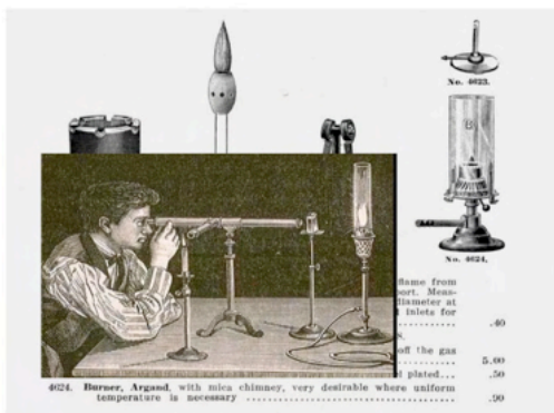
Fig. 13 - Espectroscópios tipo Bunsen-Kirchhoff, de prisma e para química (MALAQUIAS 2008) e ilustração da sua utilização.
