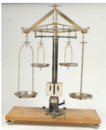
Fig. 7 - Exemplar de balança hidrostática - Projecto POCI/CED/60998/2004 - (MALAQUIAS 2008).
