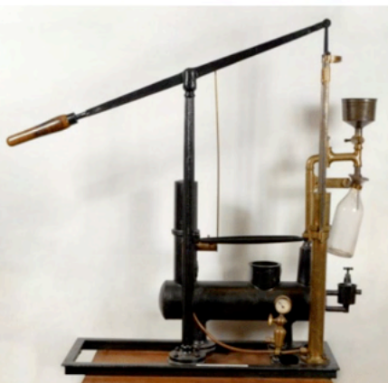
Fig. 11 - Máquina de Joule - Projecto POCI/CED/60998/2004 (MALAQUIAS 2008).
