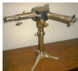
Fig. 13 - Espectroscópios tipo Bunsen-Kirchhoff, de prisma e para química (MALAQUIAS 2008) e ilustração da sua utilização.
