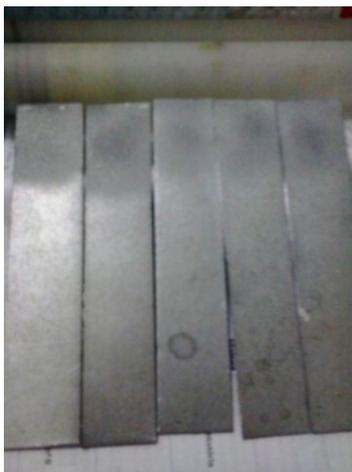
Figura 1 – Corpos de prova conforme ASTM D 1002 (2010).
