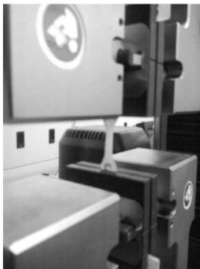
Figura 1: Ensaio de tração do adesivo (ASTM 638D, 2002).
