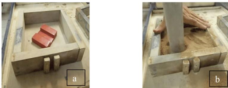
Figura 3 – a e b: Molde em madeira ao centro da caixa contentora.
