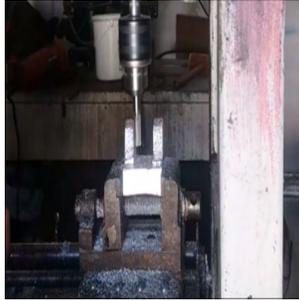
Figura 5: Fresadora caseira, aplainando as extremidades da peça.
