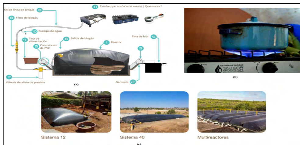
Figura 2 (a) Componentes de la instalación de producción de biogás. (b) Estufa de biogás. (c) Modelos de sistemas biobolsa instalados.
