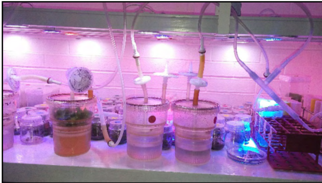
Figura 1. Sistema de inmersión temporal tipo RITA en operación
