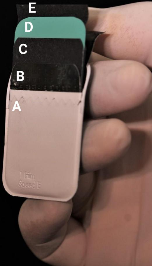
Figura 7.6. Constituintes do filme radiográfico intraoral. A. Invólucro plástico; B. Lâmina de chumbo; C. Papel opaco da face inativa; D. Filme; E. Papel opaco da face ativa.
