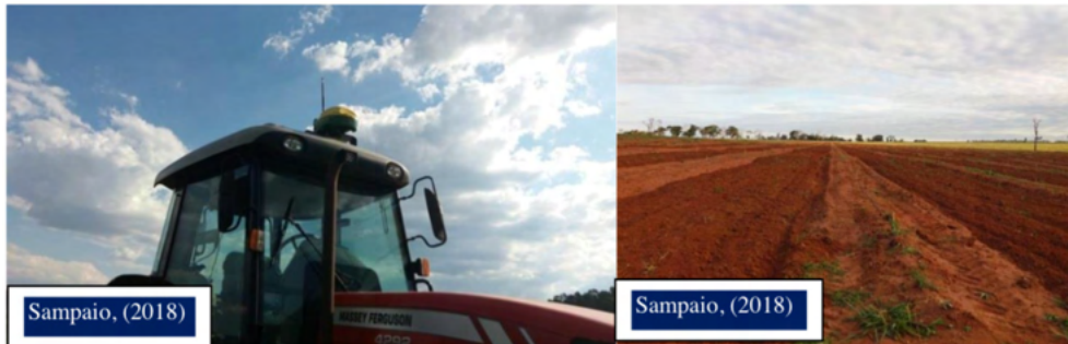
Figura 15. Equipamento GPS instalado para alinhamento de plantio, Arealva (SP).
