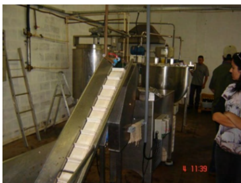
Figura 2. Vista geral da linha de uniformização e trituração da polpa de avocado 'hass' para extração de azeite, Jaguacy Brasil, 2013.
