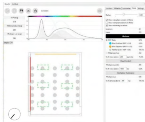
Figura 7: Sala 01 iluminação artificial.
