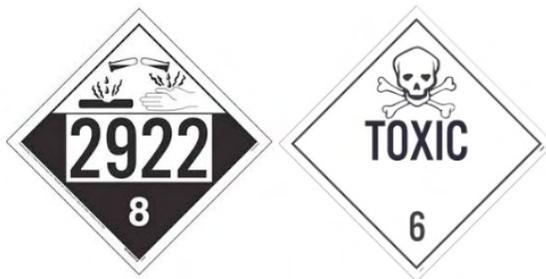
Fig. 6. Clasificación de los xantatos en forma líquida (Queensland departament of natural resources, mines and energy, 2018).
