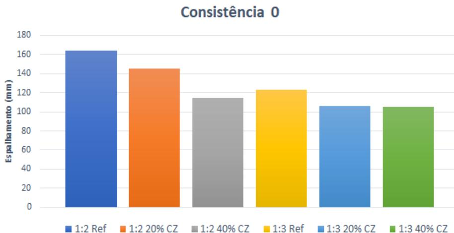
Figura 3 - Ensaio de consistência das argamassas com 0 quedas.
