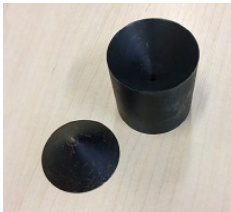
Figura 4 – Anticlépsidra e um dos cones que formam a clépsidra confeccionados em aço carbono
