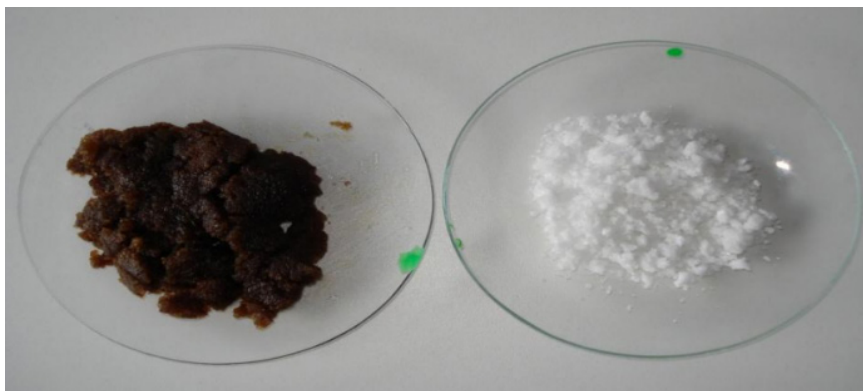
Figura 6: Sulfato de sódio obtido da purificação da glicerina antes (à esquerda) e depois (à direita) da recristalização.
