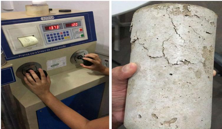
Figura 7 – Rompimento do corpo de prova
