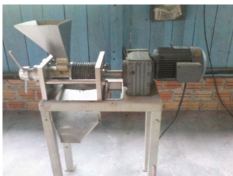
Figura 2– Prensa de retirada do óleo do babaçu na RESEX Rio Ouro Preto, município de Guajará-Mirim/RO. Set/2014.
