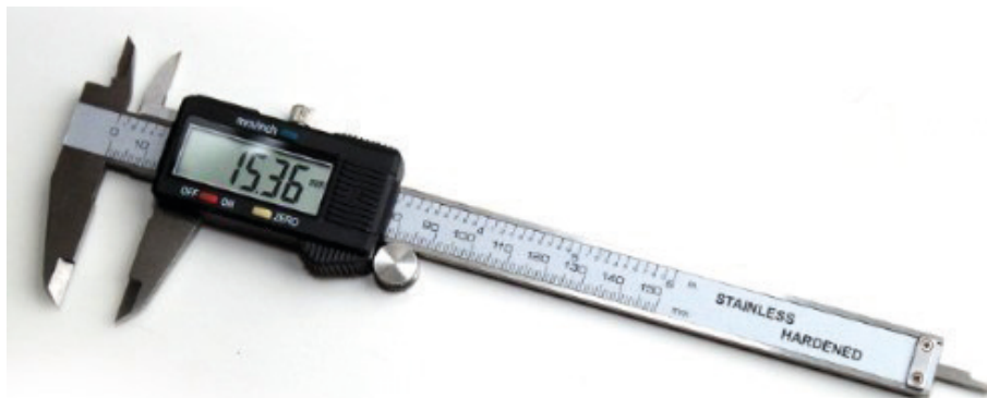
Figura 9 - Paquímetro digital utilizado na coleta de dados de diâmetro da base e diâmetro a 1,30 metros.
