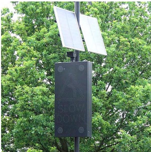
Figura 77: Sinalizador fotovoltaico <sup>[51]</sup>.
