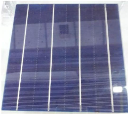
Figura 44: Célula de silício policristalino.
