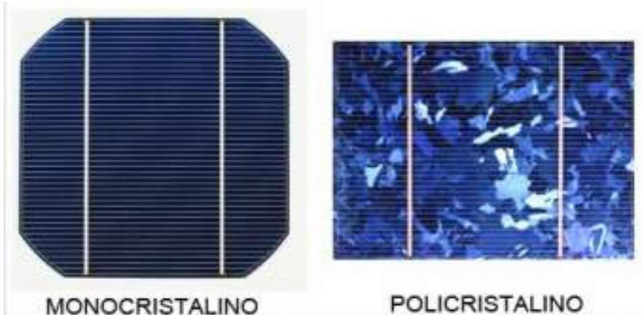
Figura 60: A célula de silício cristalino <sup>[19]</sup>.
