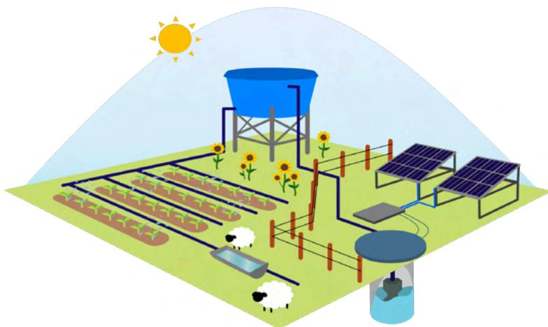
Figura 85: Esquemático de um sistema de bombeamento de água.
