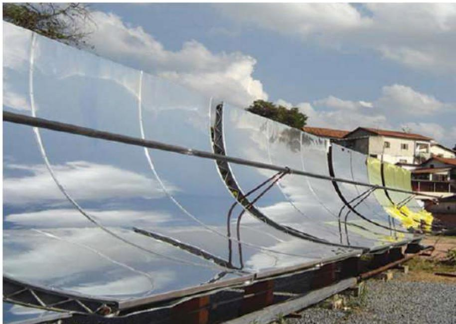
Figura 17: Concentrador solar térmico <sup>[19]</sup>.
