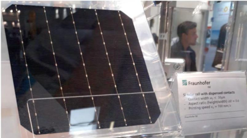
Figura 43: Célula de silício monocristalino.
