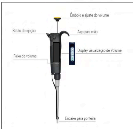
Figura 1: Partes da micropipeta automática monocanal.
