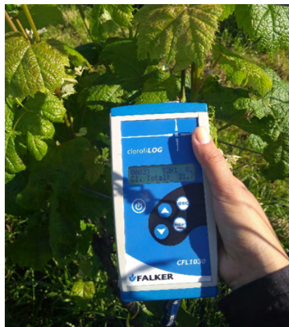
Figura 5: Avaliação de clorofila total nas folhas da Videira 'Tannat', utilizando o ClorofiLOG-CFL 1030, marca FALKER.
