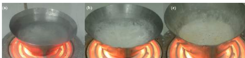
Figura 3 – Etapas de obtenção de HAp por reação de combustão, utilizando ureia como combustível. (a) Aquecimento da mistura dos reagentes na resistência, (b) liberação dos gases provenientes da combustão e (c) pós da HAp obtido após a combustão completa.
