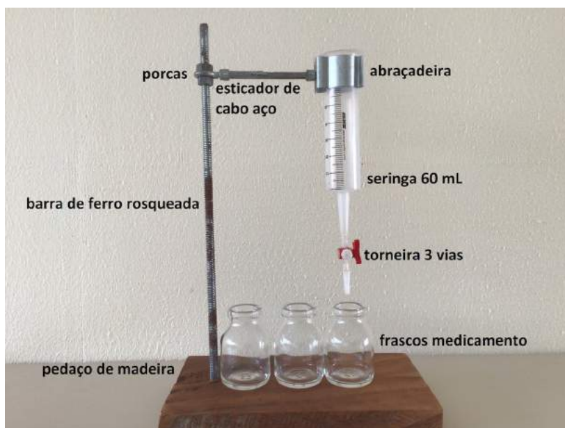
Figura 3: Kit alternativo (bureta e suporte) para titulação ácido-base.
