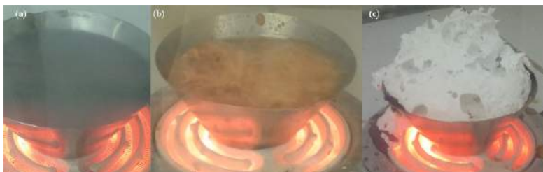
Figura 2 – Etapas de obtenção de HAp por reação de combustão, utilizando glicina como combustível. (a) Aquecimento da mistura dos reagentes na resistência, (b) liberação dos gases provenientes da combustão e (c) pós da HAp obtido após a combustão completa.
