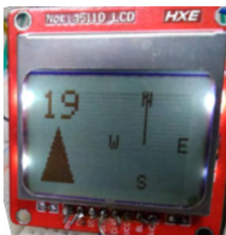
Figura 4.8 Resultado obtido pelo magnetômetro e exibido no Display LCD – Modo 2
