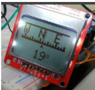
Figura 4.7 Resultado obtido pelo magnetômetro e exibido no Display LCD – Modo 1
