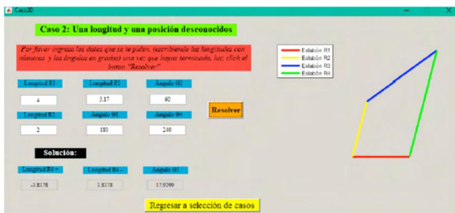
Figura 8.- Ventana de resultados del mecanismo de cuatro barras
