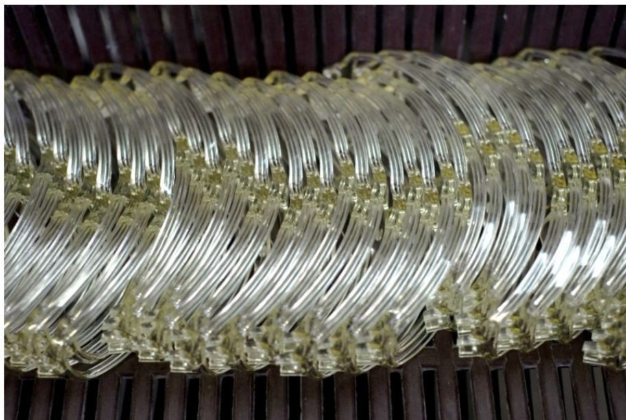
Figura 8: Frontais injetados. Imagem gentilmente cedida pela Suntech Supplies Ltda.
