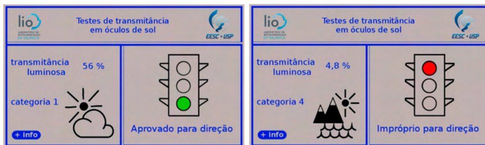
Figura 4: Exemplos de tela de resultados. À esquerda, óculos de sol aprovados para direção e, à direita, óculos de sol reprovados para direção.
