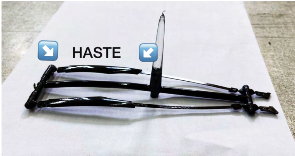
Figura 6: A haste injetada na “árvore”.
