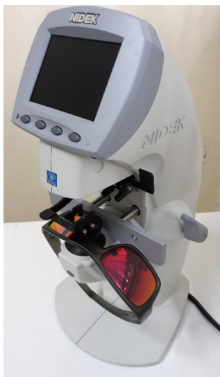
Figura 13: Foto do Lensômetro no CERTIFICA-LIO: equipamento que mede as potências esférica e astigmática, bem como desvios prismáticos das lentes.
