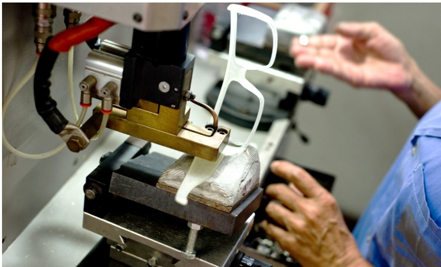
Figura 11: Inserção térmica das charneiras. Imagem gentilmente cedida pela Suntech Supplies Ltda.
