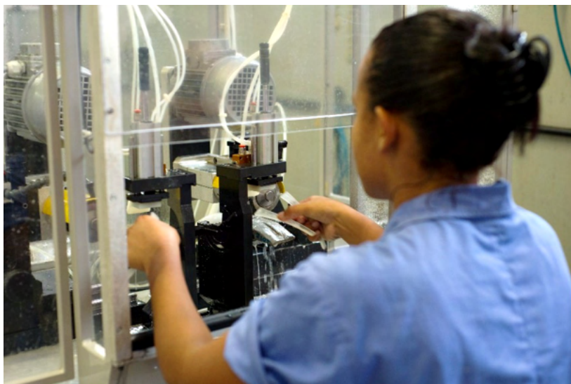
Figura 10: Corte para execução do ângulo pantoscópico. Imagem gentilmente cedida pela Suntech Supplies Ltda.
