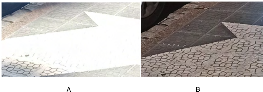
Figura 3: Comparativo entre imagens de óculos de sol: A) Imagem com lente solar convencional B) Imagem com lente solar polarizada.
