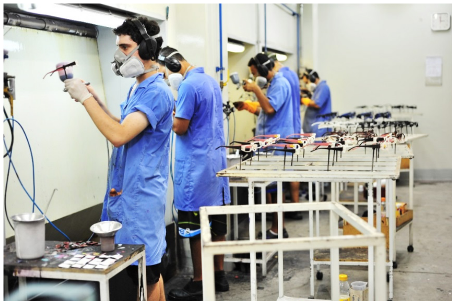
Figura 12: Processo de pintura por pulverização. Imagem gentilmente cedida pela Suntech Supplies Ltda.
