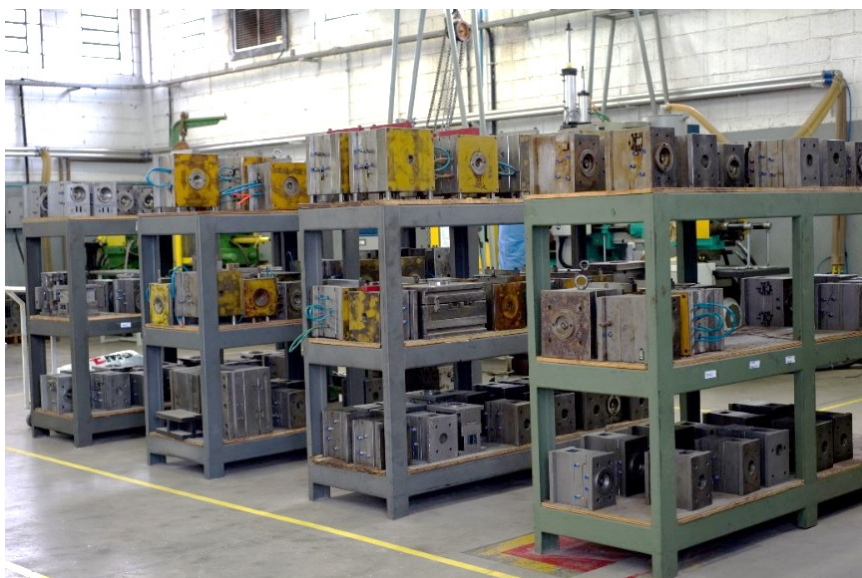
Figura 3: Estante com diversos moldes para injeção de componentes da armação. Imagem gentilmente cedida pela Suntech Supplies Ltda.
