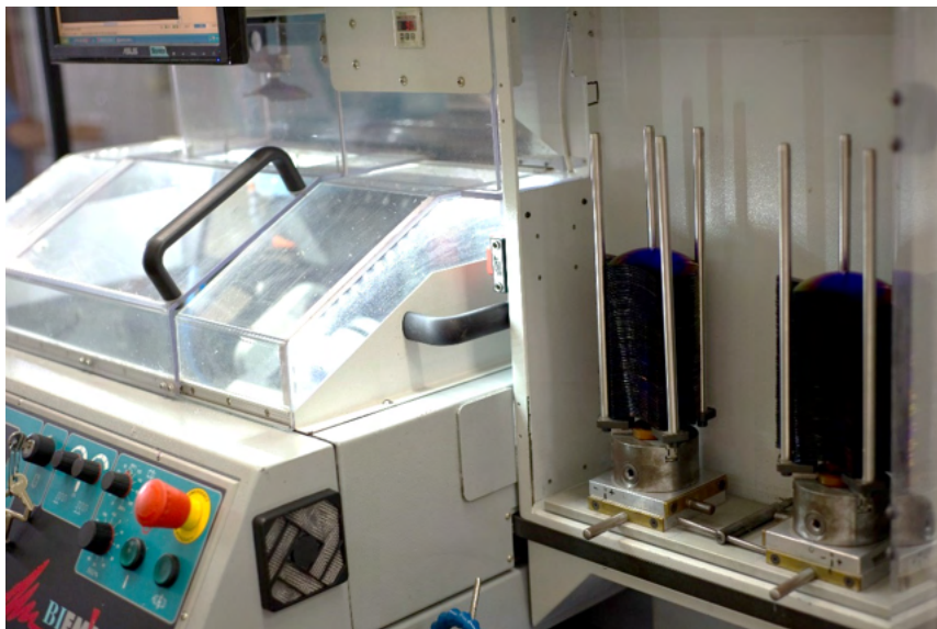
Figura 13: Sistema de fresagem computadorizada de lentes. Imagem gentilmente cedida pela Suntech Supplies Ltda.
