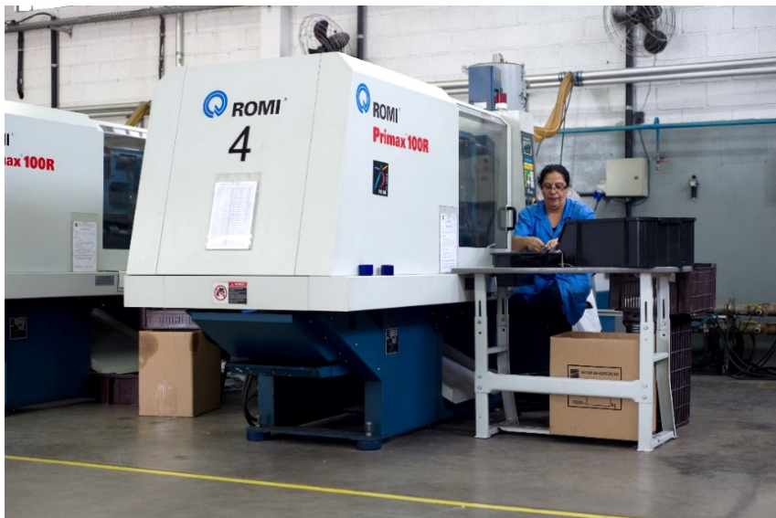
Figura 4: Máquina injetora para moldagem por injeção. Imagem gentilmente cedida pela Suntech Supplies Ltda.
