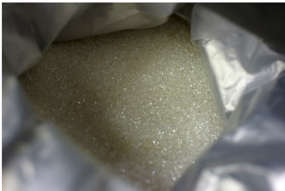
Figura 5: Poliamida granulada para injeção, na forma octaedros irregulares cuja maior dimensão está ao redor de 3 mm. São comumente chamados de “pellets”.
