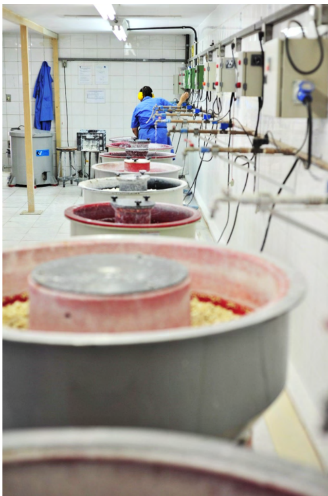
Figura 9: Acabamento superficial de componentes da armação por desbaste em vibradores circulares. Imagem gentilmente cedida pela Suntech Supplies Ltda.
