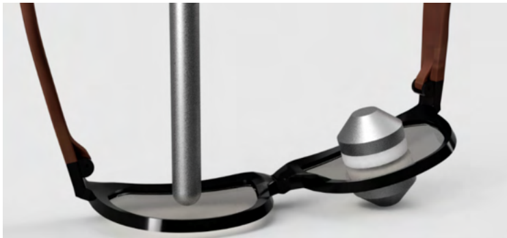
Figura 18: Esquemático do teste de resistência mecânica (crédito da figura de Igor Cordeiro Santa Bárbara).
