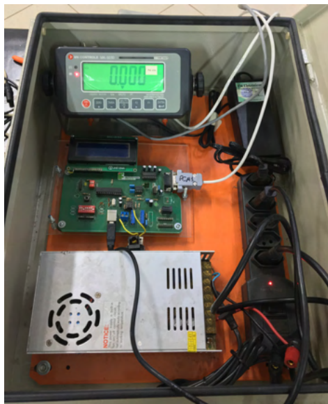
Figura 26 - Sistema para medição do torque
