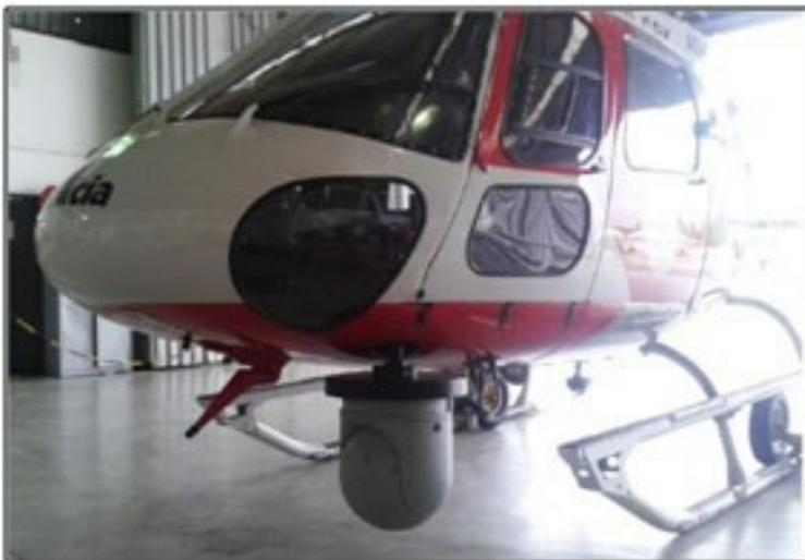
Figura 8 – Sistema de Imageamento Aerotransportado
