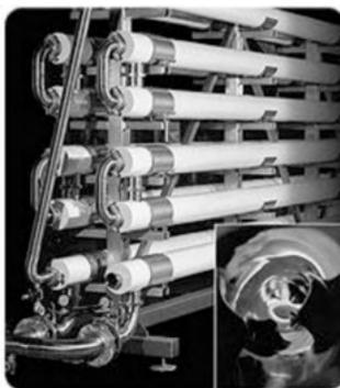
Figura 14. *Flash cooler* – detalhe do sistema de aquecimento e resfriamento.
