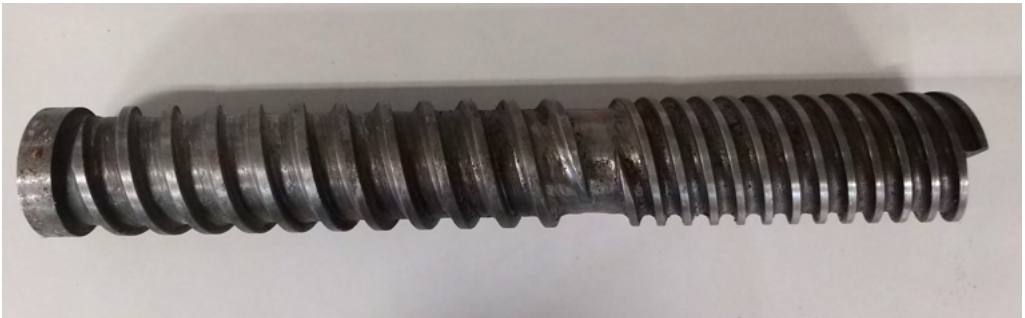
Figura 8.- Parafuso inteiriço de alta taxa de cisalhamento extrusora de canhão curto, normalmente utilizado na extrusão de grãos de milho.
