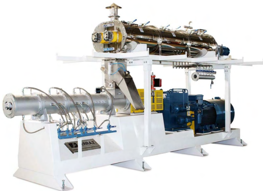
Figura 19.- Sistema de extrusão de dupla rosca da marca Ferraz®, Ribeirão Preto, Brasil.
