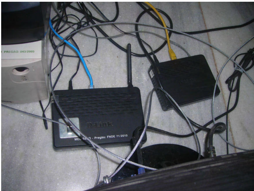
Figura 16 – Detalhe do circuito MEC (modem e roteador wireless ) na EMEF Juscelino Kubitschek
