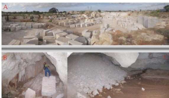
Figura 3 - Impactos observados na Toca dos Ossos (e entorno): A) antiga lavra que extraía rocha acima da caverna; B) blocos de rocha descartados no interior da caverna; C) quantidade significativa de fragmentos de rocha descartados no interior da caverna.
