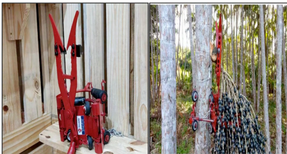
Figura 9 - Coleta do Açai usando Máquina Colhedora
