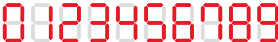
Figura 1. Algarismos arábicos representados em 7 segmentos
