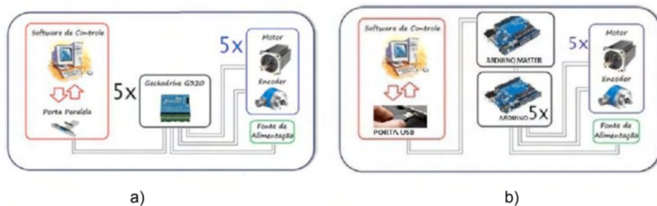
Figura 1: Arquiteturas de controle do Manipulador ASEA IRB6.
