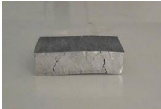
Figura 4. Amostra da liga Al-4,5% Cu solidificada direcionalmente, homogeneizada e laminada a frio na perpendicular ao crescimento de grão
