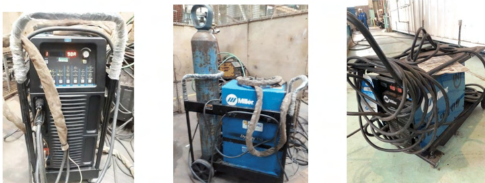
Figura 7. Máquinas TIG com fonte inversora pulsada DC e Máquina arco elétrico SMAW.
