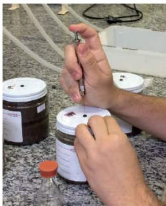
Figura 4. Amostragem dos gases com seringa cromatográfica.
