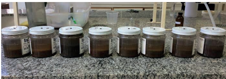
Figura 3. Frascos de headspace com as amostras e solução bacteriostática.
