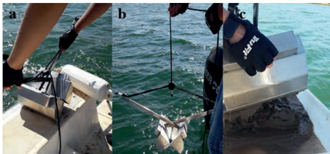
Figura 2. Procedimento de amostragem com Draga Van Veen. (a) preparação da Draga, (b) lançamento, (c) amostra de sedimento.
