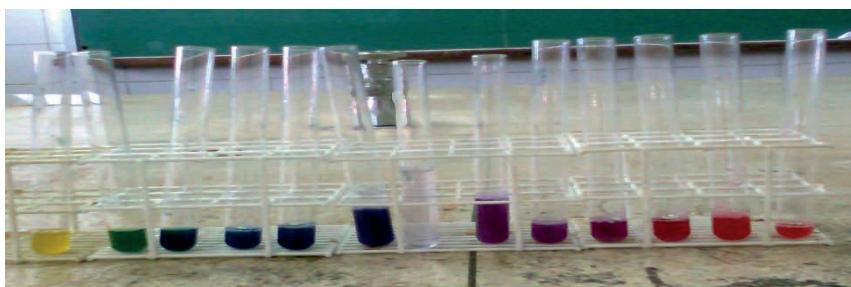
Figura 1 - Escala de pH com indicador de repolho roxo (da direita para esquerda).
