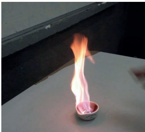
Figura 8: Oxidação da glicerina pelo permanganato de potássio.
