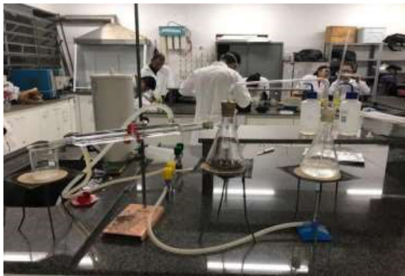
Figura 4: Montagem do esquema de arraste por vapor d'Água
