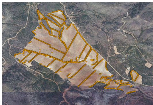
Figura 2. Medición de puntos de inicio y final de ramal, así como de las válvulas de apertura de cada subunidad mediante GPS-RTK.
