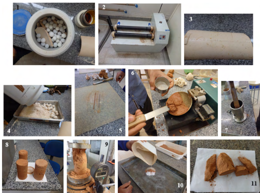
Figura 4: (1 e 2) - Fabricação de pó cerâmico em laboratório para aditivar as argamassas da Igreja do Amparo (Jarro; Bolas de Alumina e Moinho); (3) - Telha Cerâmica Branca da cidade de Itabaiana/ SE; (4) - Colocação do pó cerâmico branco moído em bandeja (processo); (5) - Rolinhos “tirinhas” ensaio Plasticidade; (6) - Ensaio Liquidez (colocação argamassa no Casagrande); (7) – Moldagem de corpo de provas para ensaio Resistência; (8) - Corpos de prova prontos para ensaio resistência; (9) - Rompimento corpo de prova amostra Teste 2 (1:6:8 sem aditivo); (10) - Preparação do corpo de prova para Teste 3 com aditivo (1:6:8 + ½ parte de pó cerâmico branco); (11) - Amostra Teste 3 (1:6:8 aditivada pó cerâmico branco) rompida. Acervo: SILVA, EDER D., mar. 2019.
