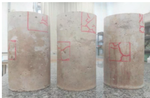
Figura 2 – Corpos de prova após análise de fissuração
