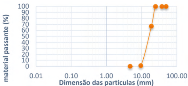
Gráfico 5. Curva granulométrica da brita comercializada por brita 19mm (granítica) município de Governador Dix-Sept Rosado – RN.
