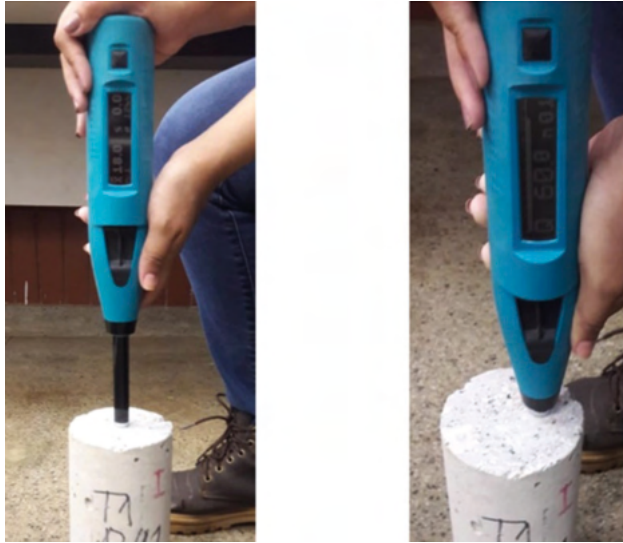
Figura 4 – Esclerômetro tipo N empregado na determinação da dureza superficial do concreto
