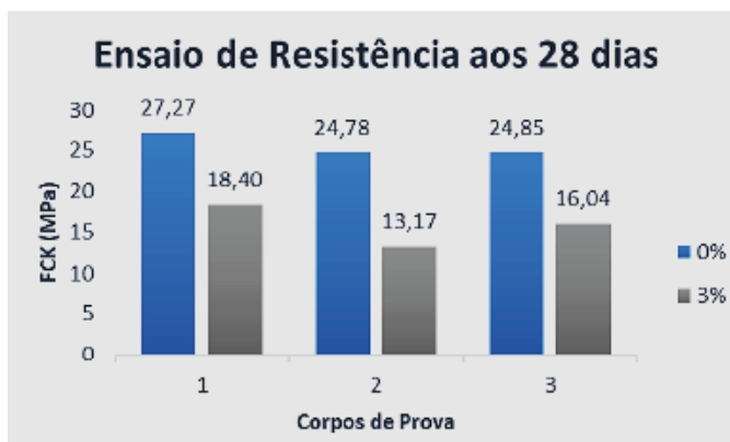
Gráfico 2 – Ensaio de Resistência à Compressão Axial aos 28 dias.
