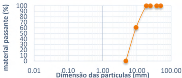
Gráfico 2. Curva granulométrica do cascalho comercializado por cascalho (granítico) na cidade de Apodi- RN.
