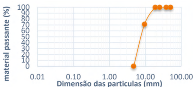
Gráfico 3. Curva granulométrica do cascalho comercializado por cascalho (granítico) no município de Felipe Guerra - RN.
