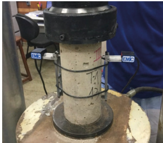
Figura 5 – Extensômetros eletrônicos empregados na determinação do diagrama tensão-deformação
