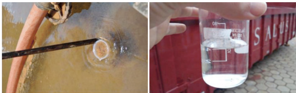
Figura 2. Amostras obtidas: (a) Lodo do decantador; (b) Percolado após os primeiros desaguamentos.
