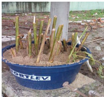
Figura 2 – Mudas plantadas no meio filtrante - Heliconia Rostrata .
