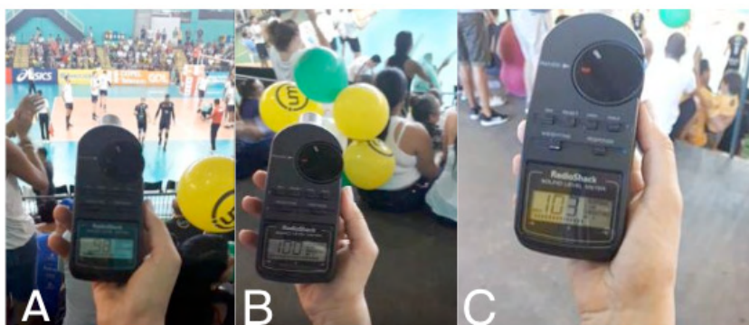
Fig. 1. Fotos de medidor de pressão sonora, indicando as intensidades de 98 dB (A), 100 dB (B) e 103 dB (C) durante jogo com torcida.
