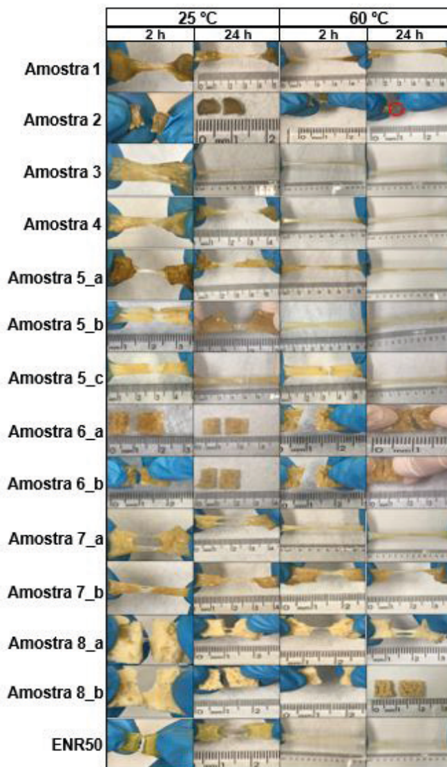
Figura 6. Ensaio de Autorreparação das amostras de ENR50
