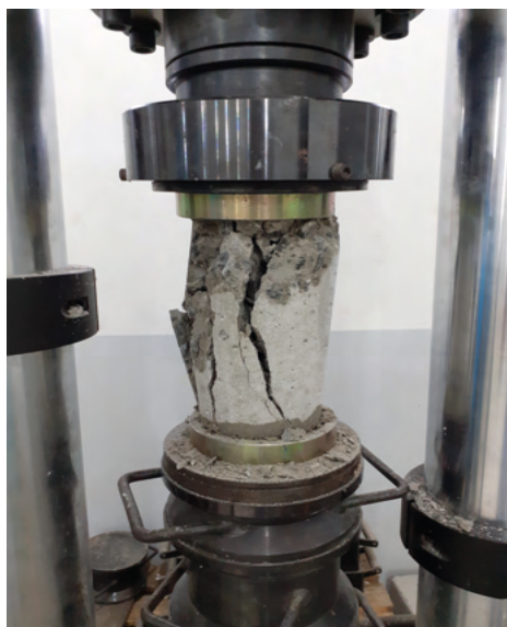
Figura 11: Rompimentos dos corpos de prova por compressão axial
