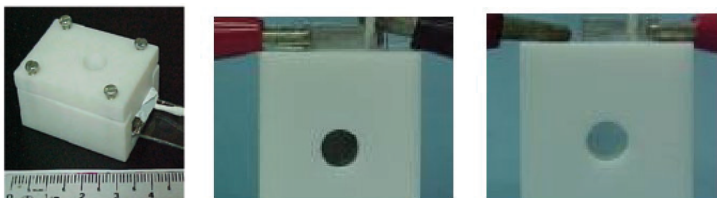
Figura 4: Coloração do dispositivo com o Gelatina e nos estados: Escuro e Claro.
