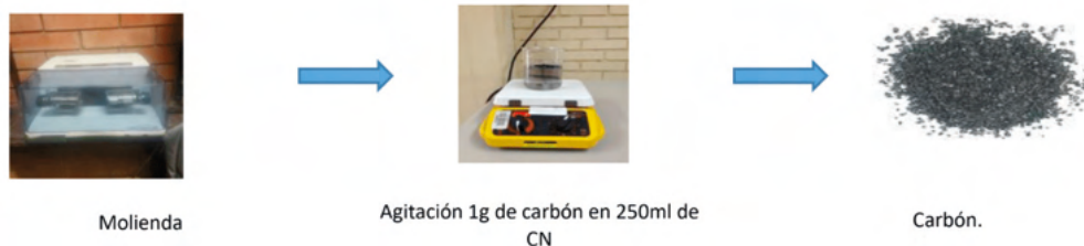
Figura 2 Adsorción de cianuro con carbón.
