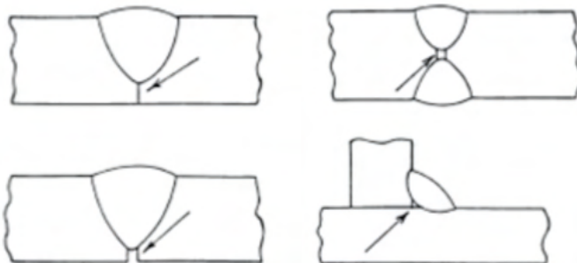
Figura 13 – Exemplo de descontinuidade na soldagem
