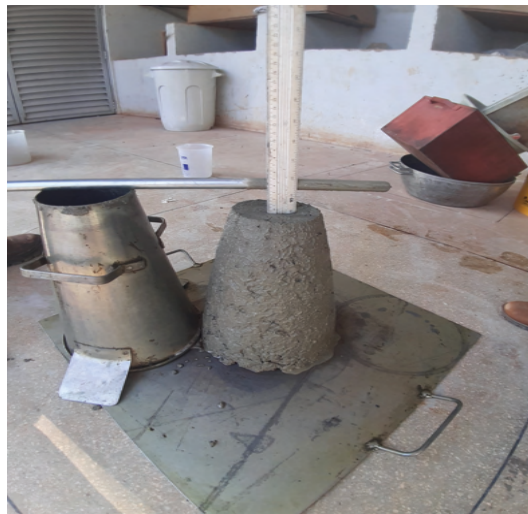
Figura 10: Concreto saturado com abatimento de 4,25 cm
