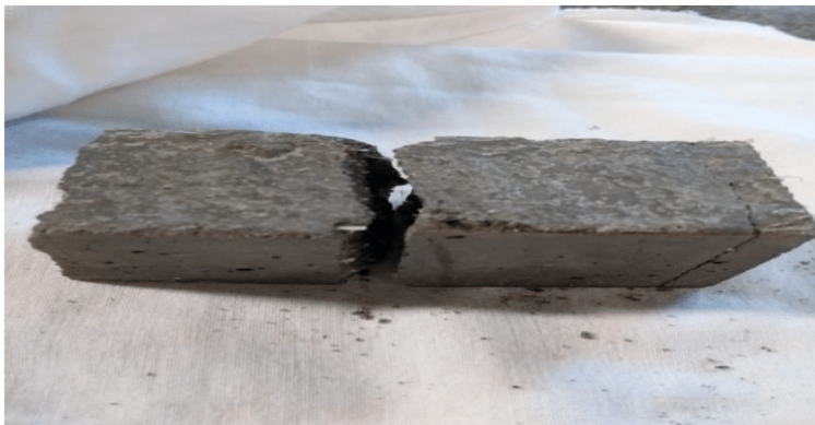
Figura 7 - Corpo de prova após rompimento pelo ensaio de tração na flexão.
