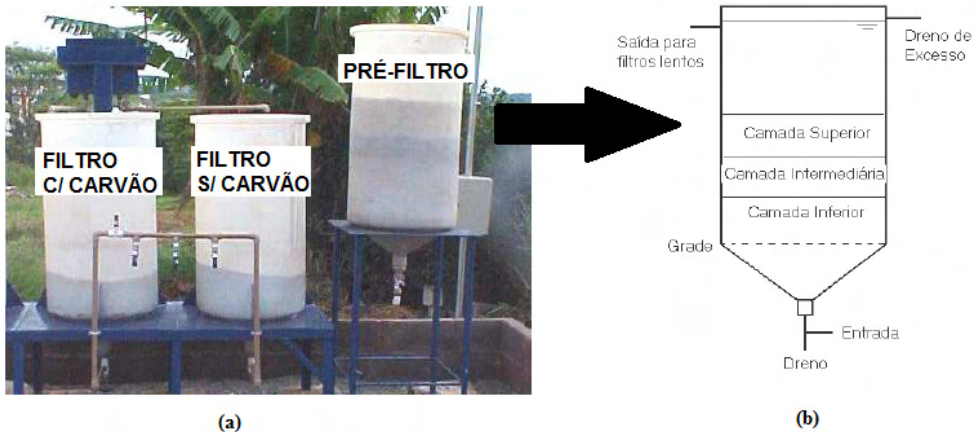
Figura 3: Vista do sistema antes da pintura (3a) e um esboço das separações de camadas internas.
