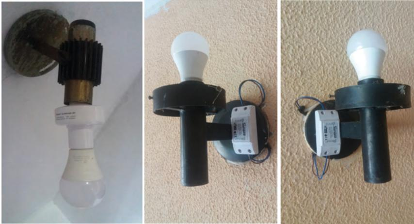
Figura 32- Lâmpadas “Egg/Corredor”, “Garagem a” e “Garagem b” com acionamento automatizado por utensílios Sonoff. Fonte: Foto e montagem do autor.
