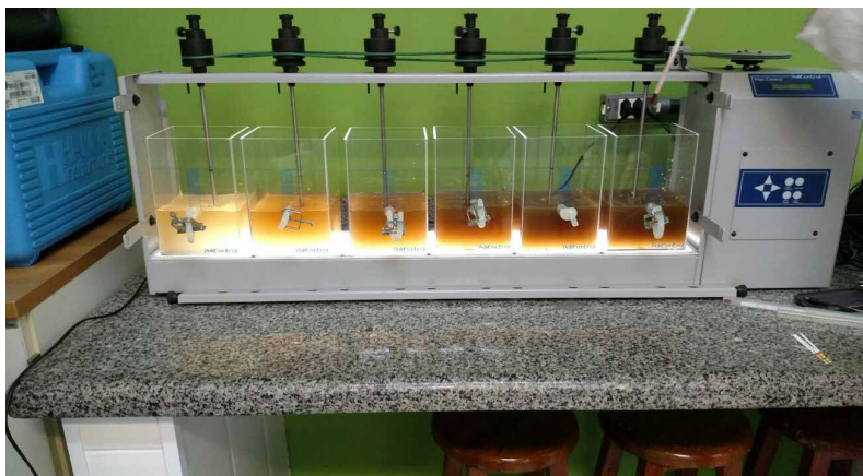
Figura 2. Ensaio para avaliar a dependência da adsorção de Cromo (VI) em função da quantidade de pó de Cocos nucífera.
