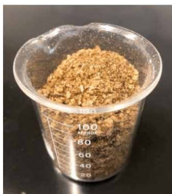
Figura 2. Película prateada do café empregada como material adsorvente nos testes de remoção de metais pesados das amostras de resíduos químicos.
