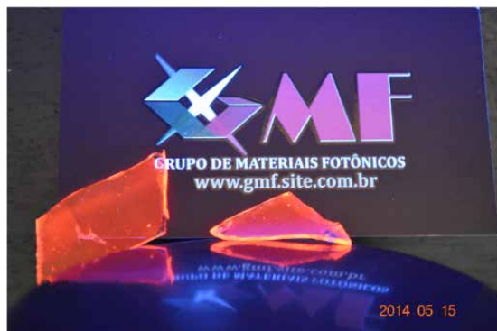
Figura 10 – Filmes luminescentes à base de \text{Eu}^{3+} obtidos por spin coating.
