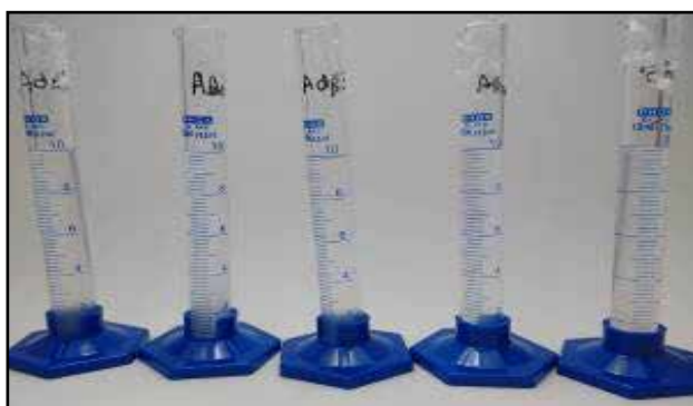
Figura 9: Imagens dos filtrados do teste de adsorção do adsorvato de azul de metileno a 6 \text{ g L}^{-1} para 100 \text{ mg} do adsorvente montmorilonita.
