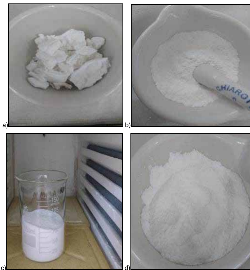
Figura 7: Imagens do processo final: a) secagem a 100 \text{ }^\circ\text{C} , b) trituração em almofariz, c) secagem a 150 \text{ }^\circ\text{C} por 24 horas e d) trituração final em almofariz.
