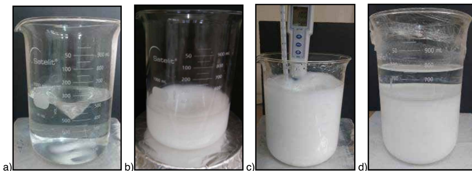
Figura 4: Imagens do processo de obtenção: a) mistura de silicato e tetrahidróxido de alumínio, b) precipitação do aluminossilicato, c) incorporação dos cátions octaédricos e d) sedimentação final antes da purificação.
