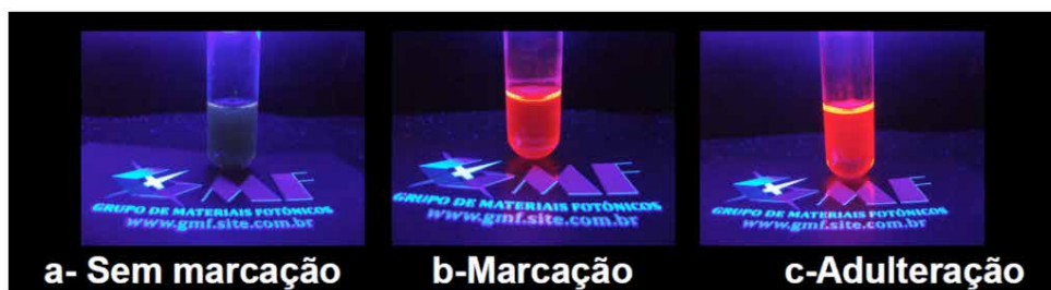
Figura 11 – Marcação de uma amostra de gasolina comum com um sistema luminescente à base de Eu^{3+} e adulteração da mesma com etanol.
