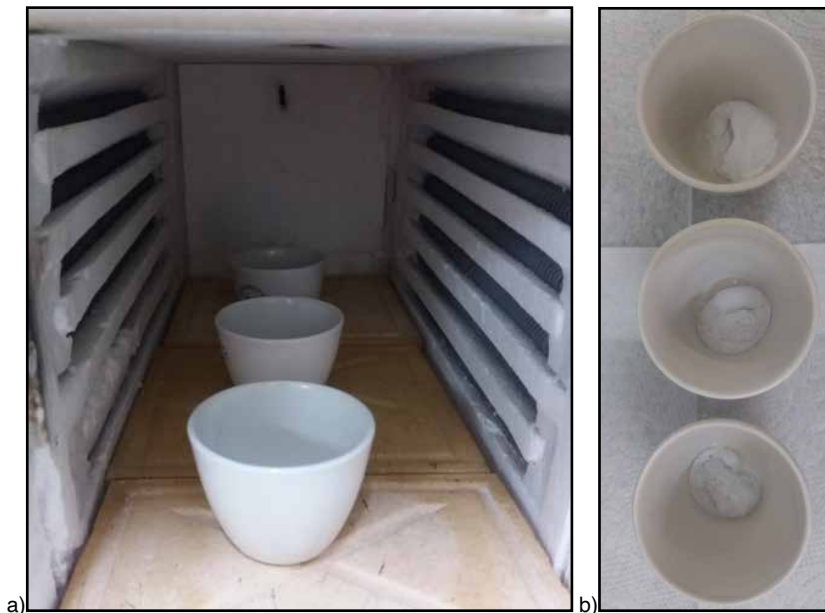
Figura 3: Imagens do processo de padronização do reagente metassilicato de sódio hidratado: a) durante calcinação e b) após pesagem final.
