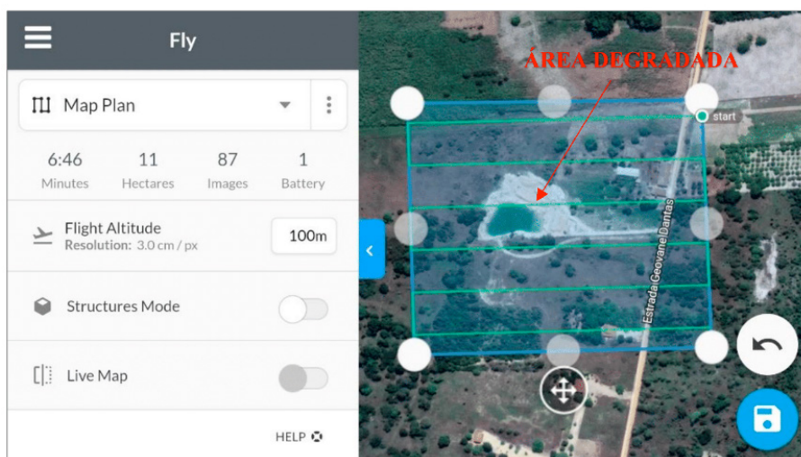
Figura 5 - Plano de voo de uma área de extração. Este método determina a área sobrevoada, como também a quantidade de imagens que serão obtidas.
