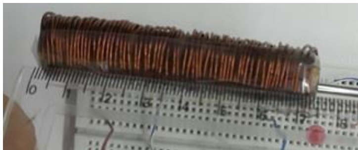
Figura 2 – Solenoide A feito de tubo de cobre revestido por fio de cobre de 1 mm, com comprimento de 7,5 cm.
