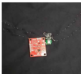
Figura 5 – Sensores de umidade e de frequência cardíaca aplicados na blusa.
