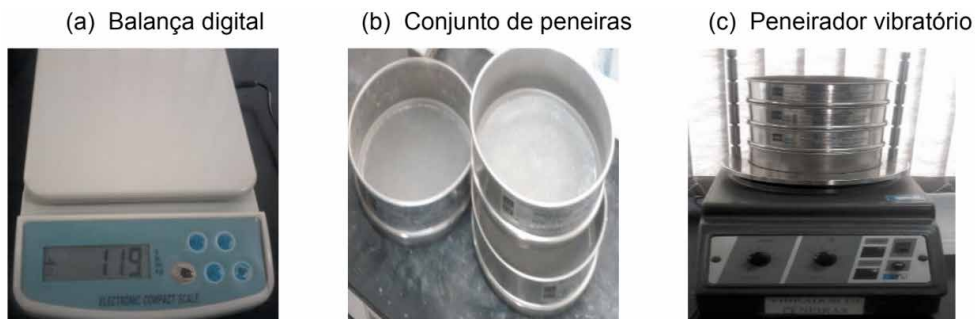
Figura 6 - Equipamentos utilizados para medir a distribuição granulométrica, autoria própria.
