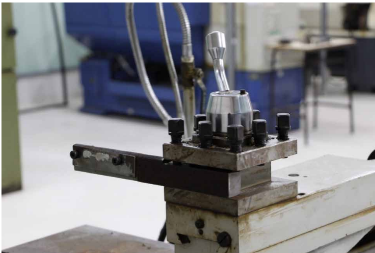
Figura 8 - Dispositivo de fixação rápida para placa substrato.
