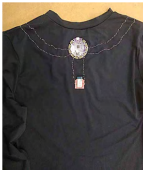
Figura 6 – Microprocessador e bluetooth aplicados na blusa.
