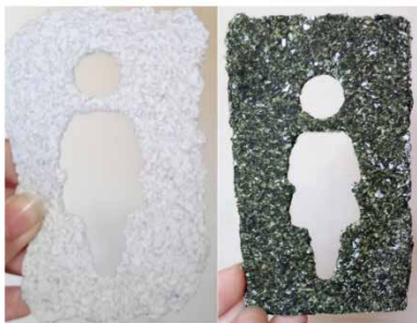
Figura 6. Placas, com cor natural e pigmentada, fabricadas com amido e papel.
