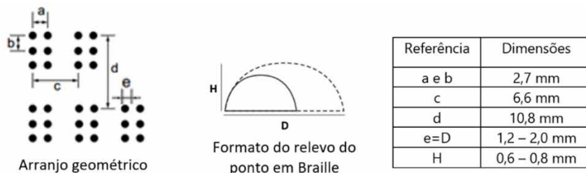
Figura 3. Dimensionamento do ponto em Braille (ABNT, 2015).
