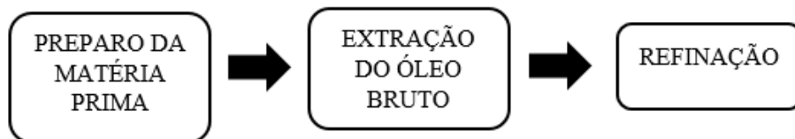
Figura 3: Etapas do processamento de óleo de oleaginosas.
