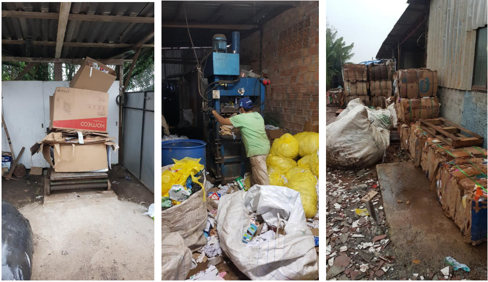
Figura 3. Pesagem dos resíduos, prensagem e armazenamento dos fardos.
