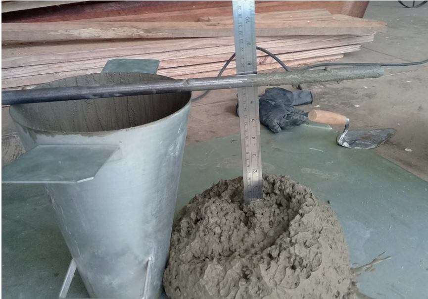
Figura 3. Conferência do abatimento do tronco de cone com a régua milimetrada.
