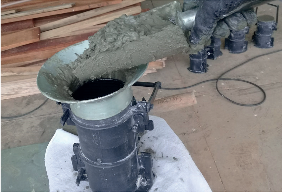
Figura 4. Moldagem dos corpos de prova (CPs) cilíndrico de concreto, com 100 mm de diâmetro e 200 mm de altura.
